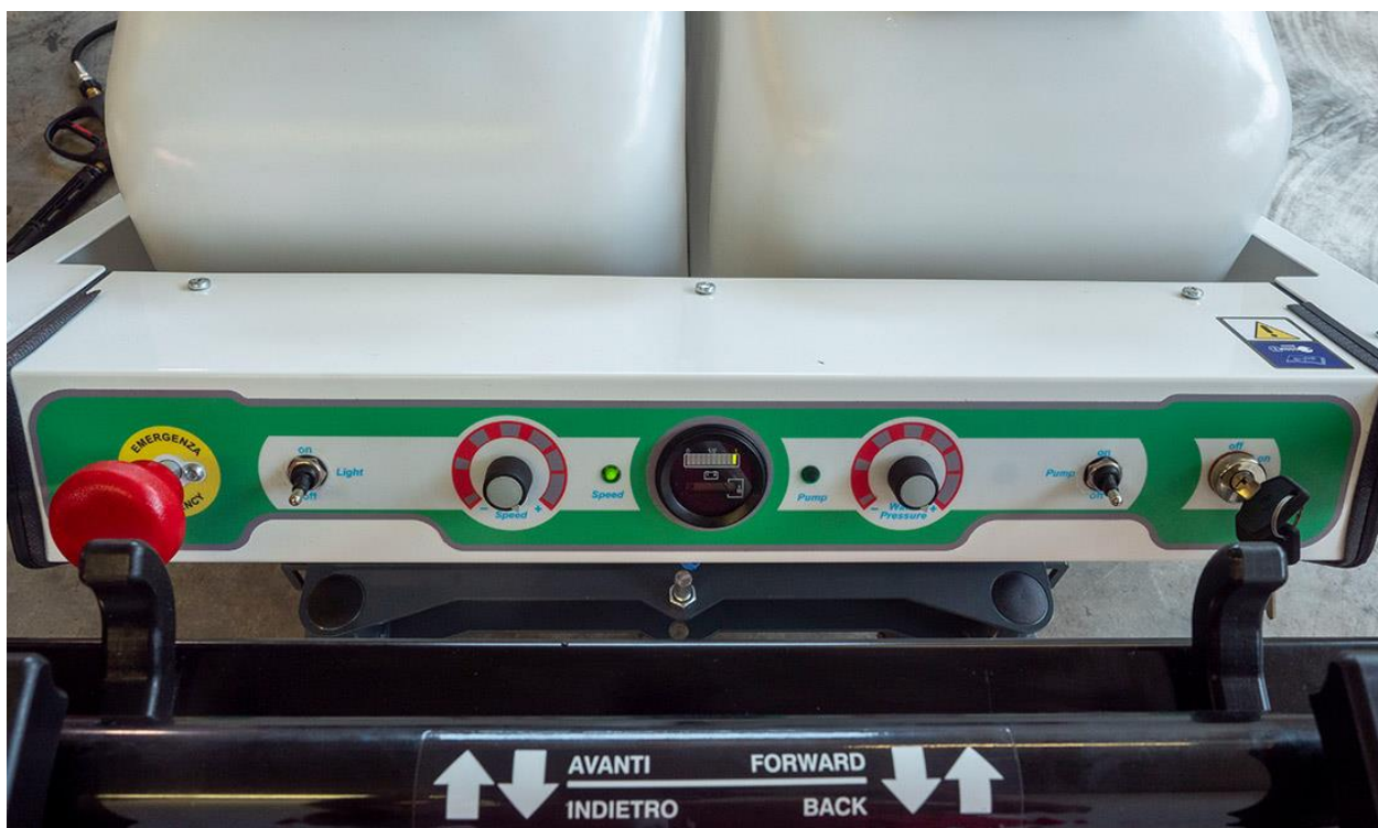
Kezelőegység: vészleállító, világítás kapcsoló, sebesség állító, akkumulátor szint és munkaóra kijelző, víznyomás állító, ki-be kapcsoló, indítókulcs
