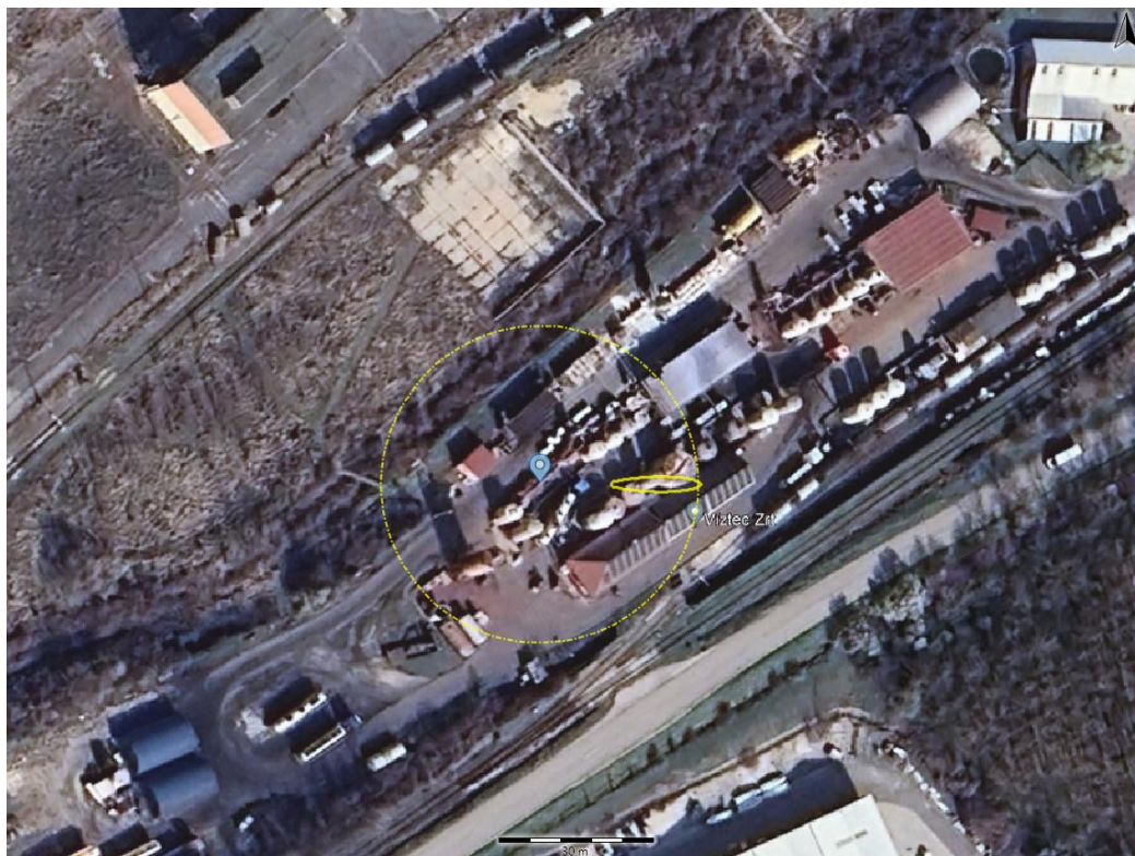
20. ábra Sósav gáz terjedése F1 légállapot esetén 1. kiindulási pont
