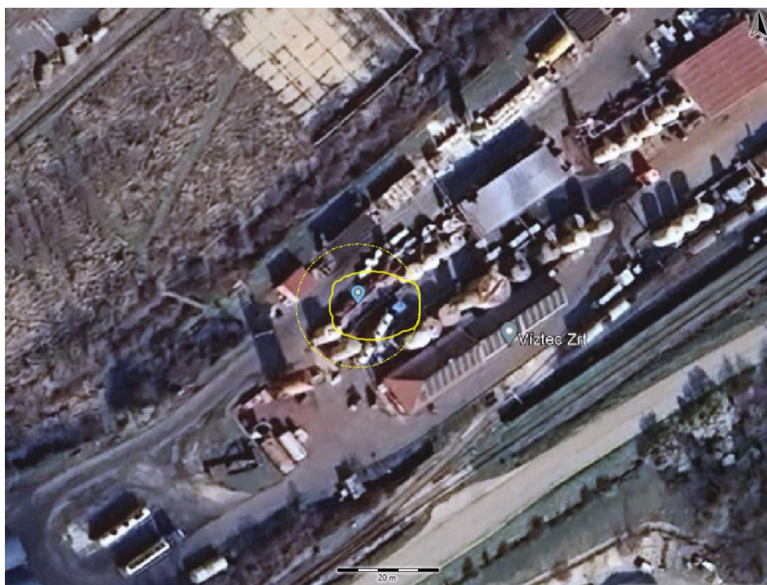
16. ábra Sósav gáz terjedés F1 légállapot esetén 1. kiindulási pont
