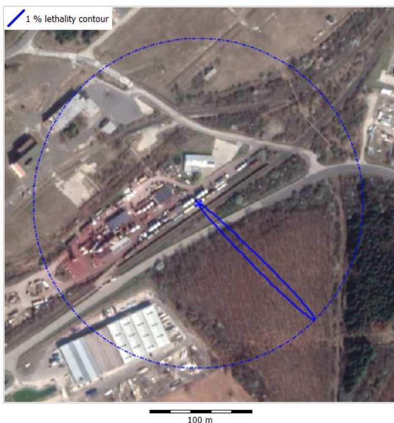
13. ábra: A salétromsavas vasúti tartályvagon töltő-lefejtő tömlőjének/karjának teljes keresztmetszetű sérülése esetén létrejövő 1%-os halálozási kontúr (F1 légkör állapot)
