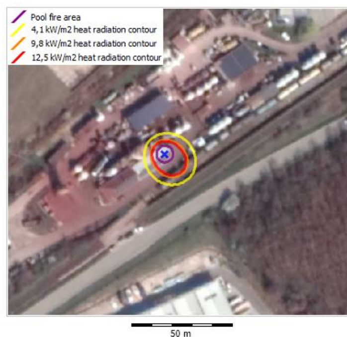
14. ábra: Gázolaj kikerülése esetén keletkező tócsatűz
