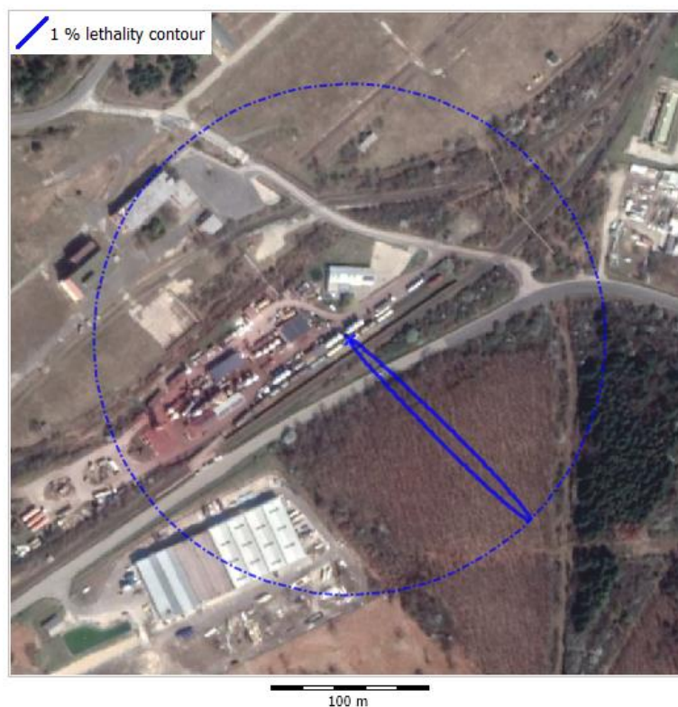
12. ábra: A salétromsavas vasúti tartályvagon katasztrofális sérülése esetén létrejövő 1%-os halálozási kontúr (F1 légkör állapot)
