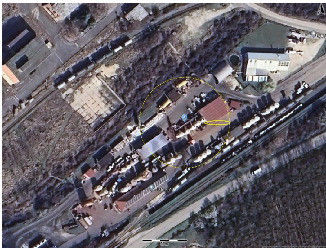
22. ábra Sósav gáz terjedése F1 légállapot esetén 3. kiindulási pont
