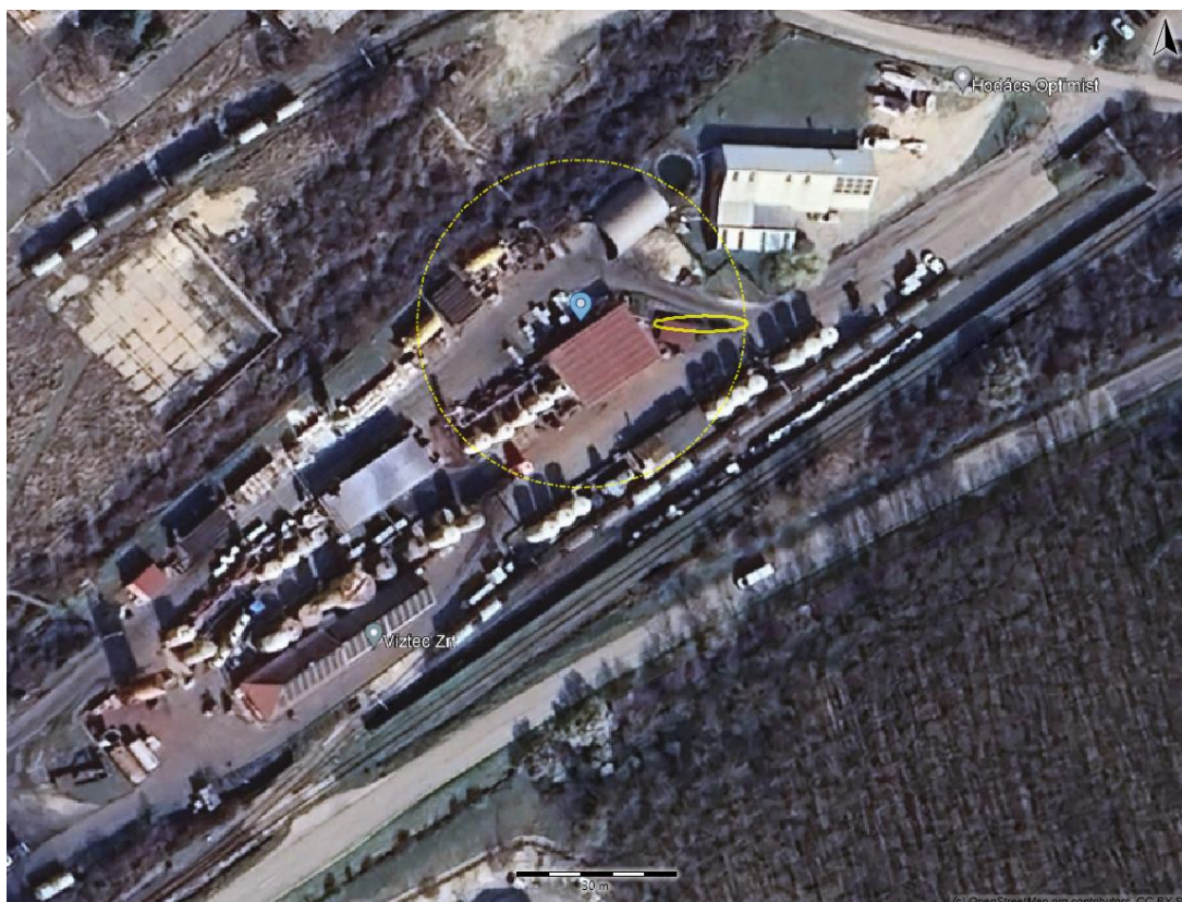
23. ábra Sósav gáz terjedése F1 légállapot esetén 4. kiindulási pont
